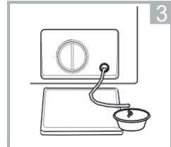
Después de que se agote el agua, reinserte la manguera de drenaje.
